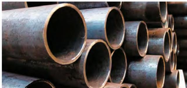
*осваивает технологию проката крекинговых труб из хромосодержащих сталей. Благодаря существующему научно-техническому заделу и слаженной работе заводских специалистов мы в короткий срок запустили производство принципиально нового продукта и в декабре 2020 года отгрузили опытно-промышленную партию труб из стали 15X5M. В ближайшей перспективе мы рассчитываем выйти на промышленные объемы выпуска этой продукции», – отметил управляющий директор СинТЗ Вячеслав Гагаринов.*
